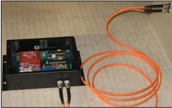
Slika 8. Optički link za VN merenja
