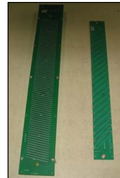
Slika 7. Spoljni izgled samostalnog VN otpornika za merenje napona elektrofiltera
